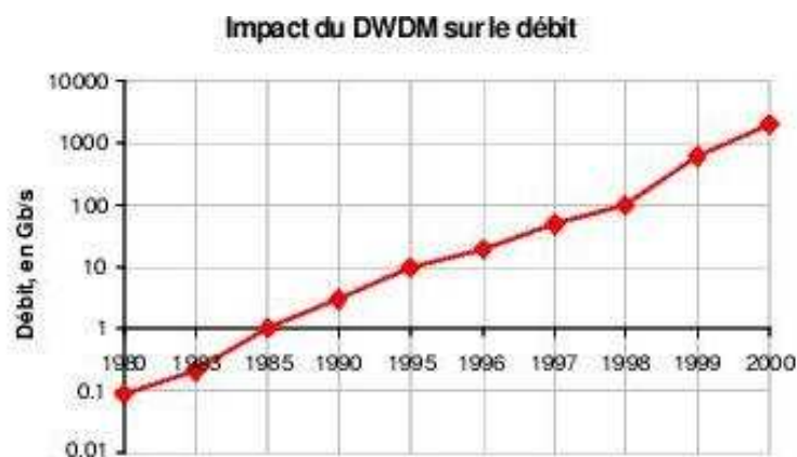
FIG. 3.14 – Impact des technologies DWDM sur le débit des réseaux optiques.
