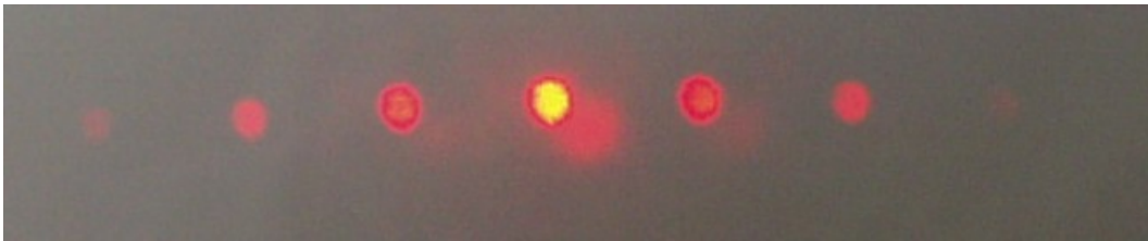
Figure 18 : figure de diffraction d'un réseau carré (ensemble de points équidistants dont le nombre tend vers infini et d'intensité variable)
